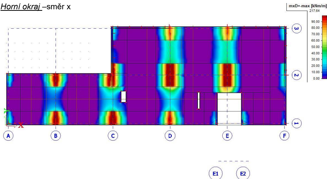
Obr. 54 Ohybové momenty u horního okraje směr x
