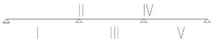
Obr. 8 Statické schéma průvlastu R9
